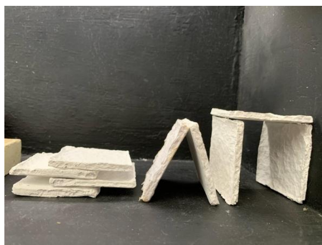
Figura 16 – Pastilhas de papel confeccionadas com polpa.
