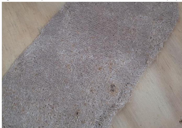
Figura 11 – Papel com fibras de miriti, confeccionado com polpa.
