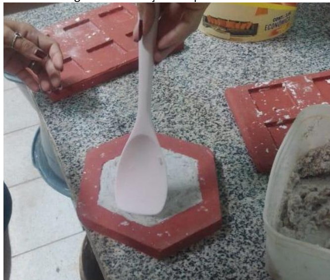
Figura 5- confecção das partes da caixa
