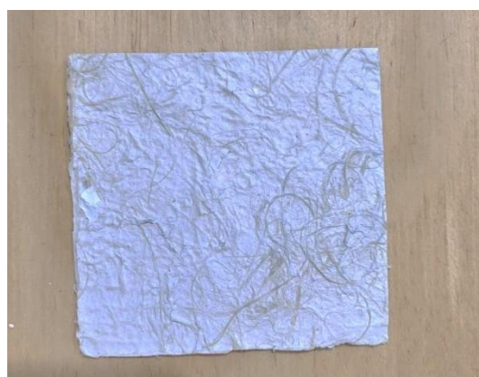
Figura 14 – Papel reciclado com fibras de juta.
