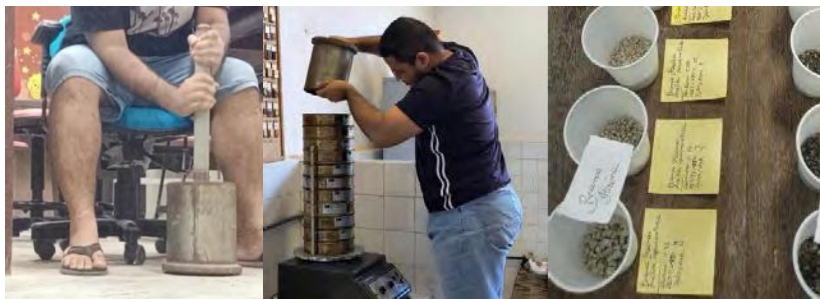
Figura 14 – Trituração, agitação eletromagnética e separação dos fragmentos
