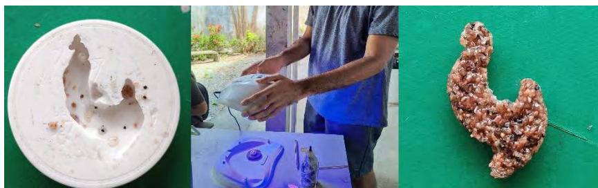
Figura 15 – Uso de molde, cabine de LED UV e peça obtida
