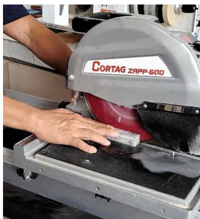
Figura 5 – Corte com o cortador elétrico CORTAG Zapp 600
