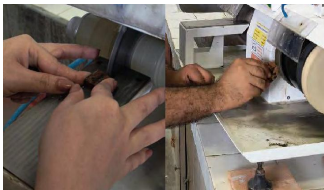
Figura 10 – Corte da amostra na lapidadora e uso do rebolo diamantado
