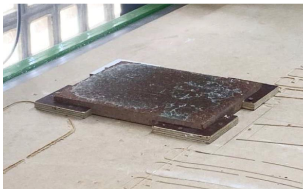
Figura 7 – Placa de compósito fixada na superfície da Router com gabaritos em madeira antes de usinagem.
