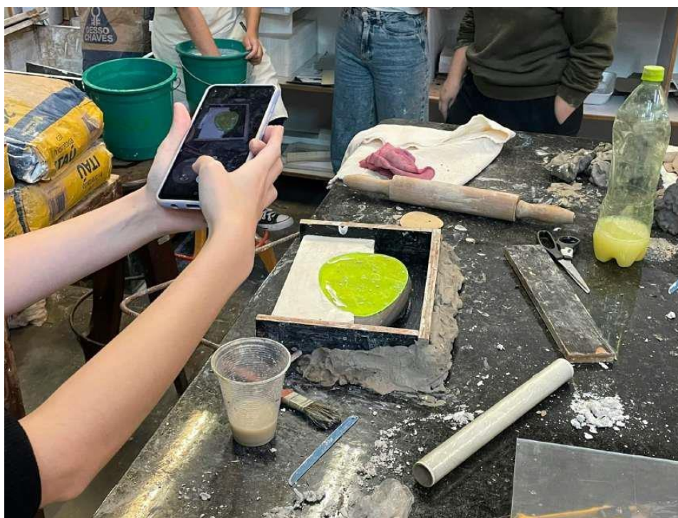
Figura 3 – Produção lateral esquerda do molde em gesso para o prato.
