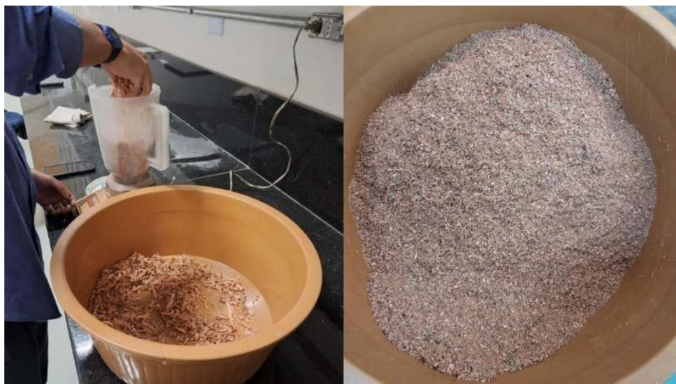
Figura 4 – À esquerda, fibra de madeira sendo triturada em liquidificador. À direita, fibras trituradas.
