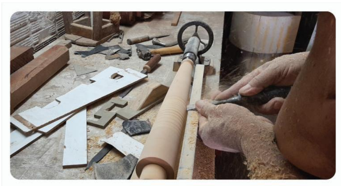
Figura 11 - Torneamento e goivas adaptadas
