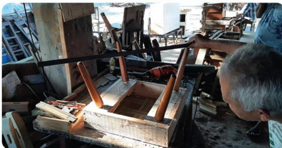
Figura 9 - Alinhando móvel com a estratégia do nivelamento
