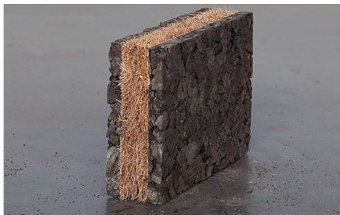
Figura 1- Composto de fibra de coco com cortiça.
