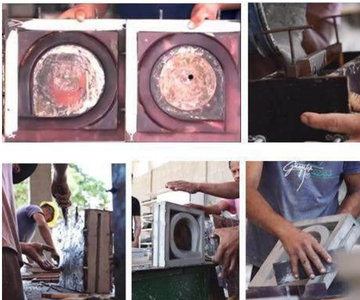
Figura 14 – Processo de fabricação do cobogó Tesourinha pela empresa Alegrelar
