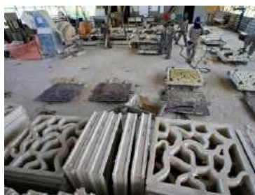
Figura 6 – Processo de fabricação do Cobogó Cais do Sertão na própria obra
