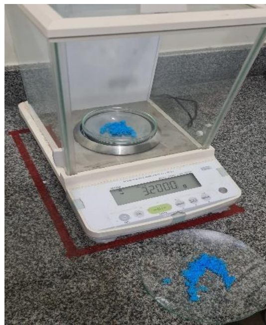
Figura 2. Balança de precisão com sulfato de cobre.
