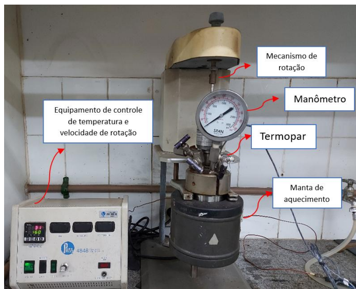
Figura 1. Reator de aço inoxidável utilizado na reação de oxipropilação.
