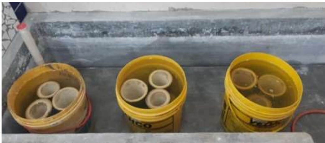
Figura 4 – Tratamentos do bambu: Água, Timbor e Hidróxido de sódio
