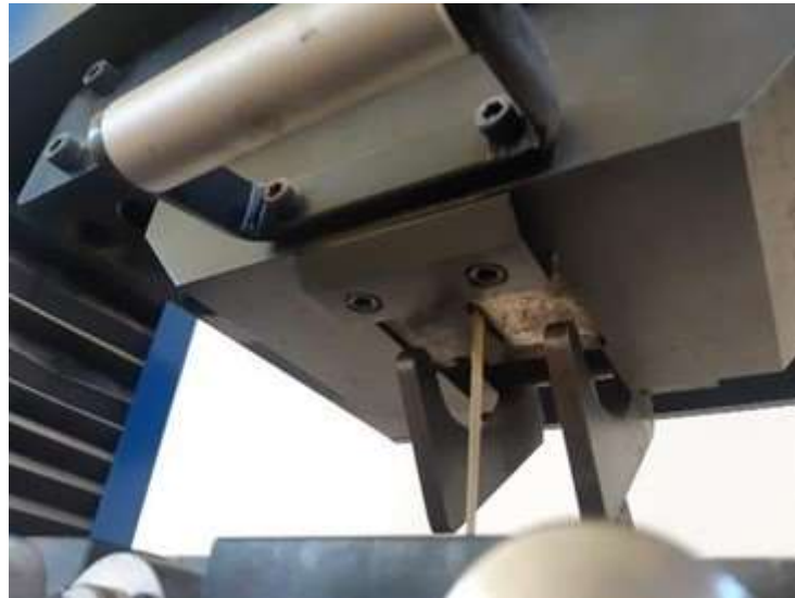
Figura 7 – Fixação do corpo de prova nos mordentes
