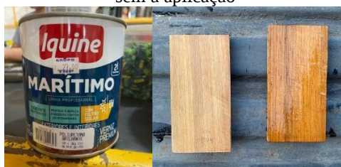
Figura. 5- (A) verniz marítimo da marca Iquine; (B) diferença de uma madeira com aplicação de verniz e outra sem a aplicação
