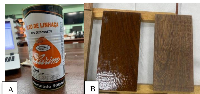
Figura. 4- (A) Óleo de linhaça da marca “Clarim”; (B) aspectos da madeira com a aplicação do produto e in natura.
