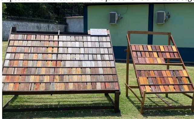
Figura. 7 – Amostras dispostas no cavalete em inclinação de 45° e orientadas segundo o eixo leste-oeste.
