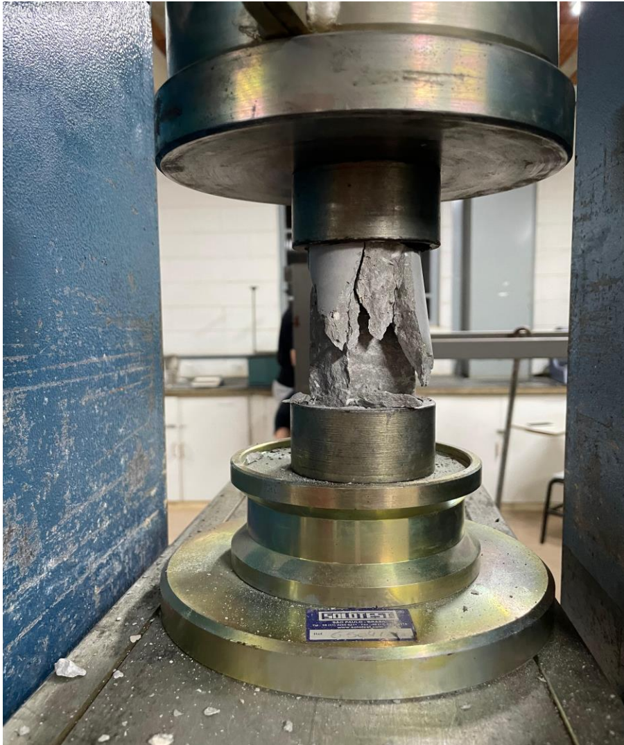
Figura 2.3 - Ensaio Laboratorial de compressão
