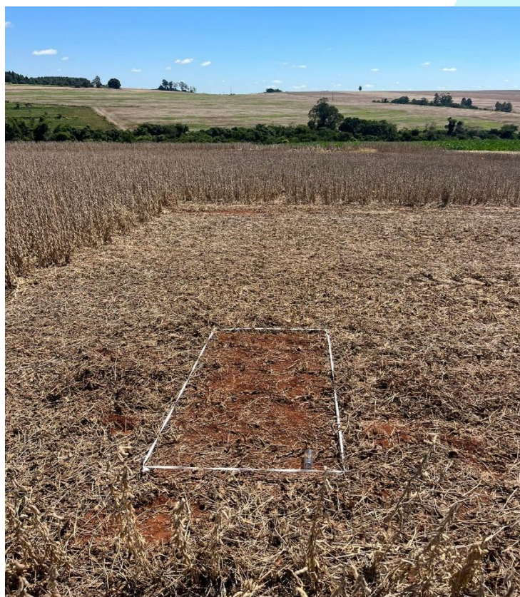
Figura 3- Área de amostragem para contagem de grãos perdidos após colheita.
