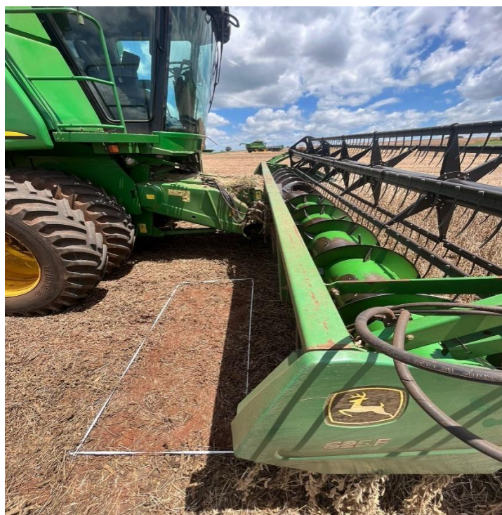
Figura 2-Posicionamento da amostragem do gabarito após a colheita com o sistema helicoidal.
