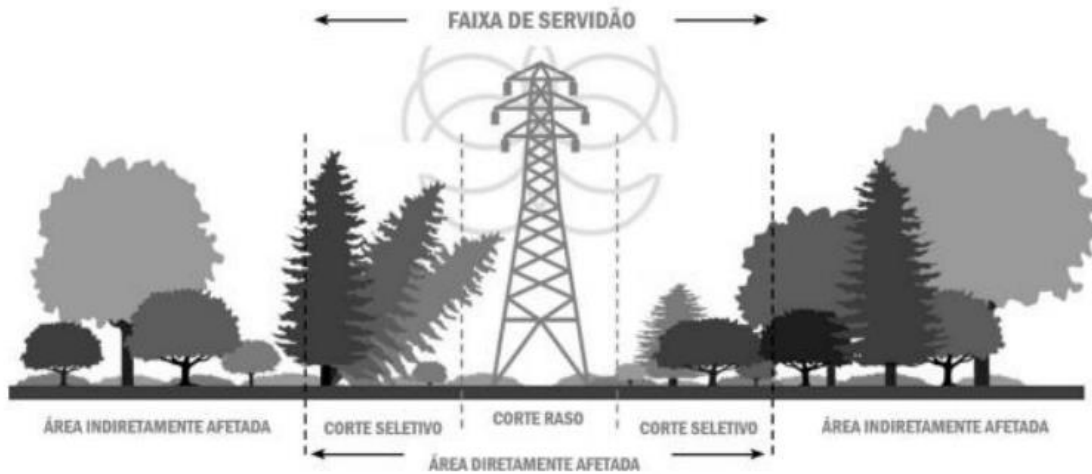
Figura 3. Faixa de servidão e áreas afetadas diretamente e indiretamente pelas linhas de transmissão (Fonte: Biasotto, 2017).
