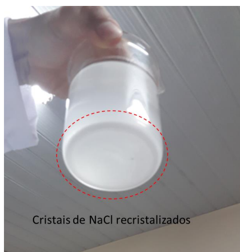
Figura 4. Recrystalização e precipitação de cristais de cloreto de sódio (NaCl) a partir da solução saturada. Fonte: Autores (2024).
